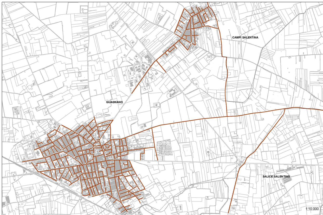
Figura 15: rete fognaria dell'abitato di Guagnano (Fonte: AQP)
